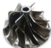
Mini-réacteur pour des essais à l'échelle fabriqué en LaserForm 17-4PH (A)
