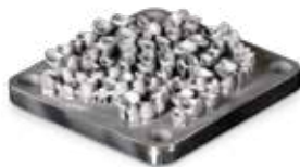
Production de partiels, coiffes et bridges en LaserForm CoCr (C)
