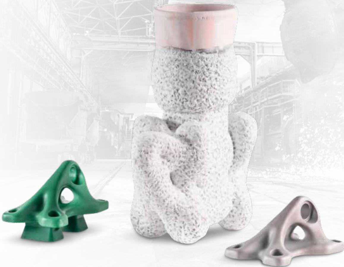
Le soluzioni di produzione digitale senza stampi di 3D Systems hanno cambiato le prospettive della fusione a cera persa con la stampa 3D di modelli di fusione in resina e cera di alta qualità, in uno scenario che prevede la produzione di parti in metallo di elevata complessità in poche ore e a costi notevolmente inferiori.
