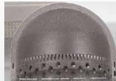
Dôme de 15 mm de diamètre imprimé sans support
