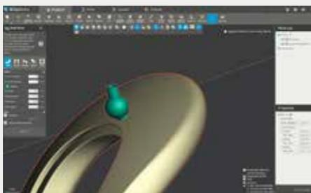
Lorsque vous placez les aérations et les canaux secondaires d'injection, faites attention aux surfaces critiques et tenez compte du fait que le moule sera placé à l'envers pendant le processus de nettoyage.
