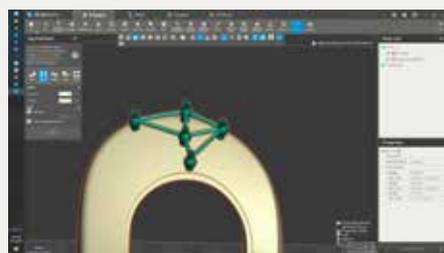
Placez le canal secondaire d'injection entre les deux faces intérieures de la pièce pour permettre au silicone d'atteindre plus facilement l'intérieur de l'autre côté de la pièce.
