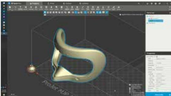
高解像度のインポート設定を使用することで、小型で薄いフィーチャを保持し、フィーチャがファセット化されたり、単純化され過ぎたりするのを防ぐことができます。これは、単純なものから複合的なものまで、どのような種類の曲率の部品にとっても最適です。
