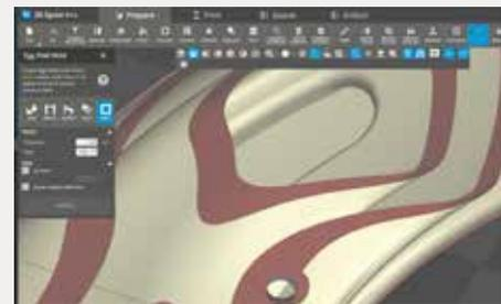
3D 프린팅 기술 선택에 따라 부품 오프셋도 달라집니다. SLA와 Figure 4를 선택하면 벽면 두께를 0.3mm까지 낮춰서 에그셀 금형을 프린트할 수 있습니다. MJF의 경우에는 벽면 두께를 최소 0.8mm로 설정하여 부품을 프린트하는 것이 좋습니다. 또한 부품에 내부 공동이나 넓은 평면 또는 물결 모양 표면이 존재하는 경우에는 구조적 리브, 격자 서포트 같은 보강재를 추가로 사용하는 것이 유용합니다.
