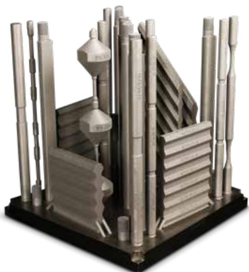
Plaque d'impression pour le test des propriétés mécaniques
