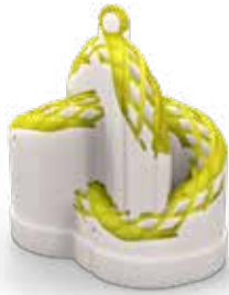
Visijet Crystal en material de soporte
